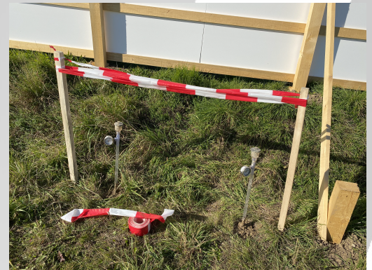
Mise en place de tensiomètres
